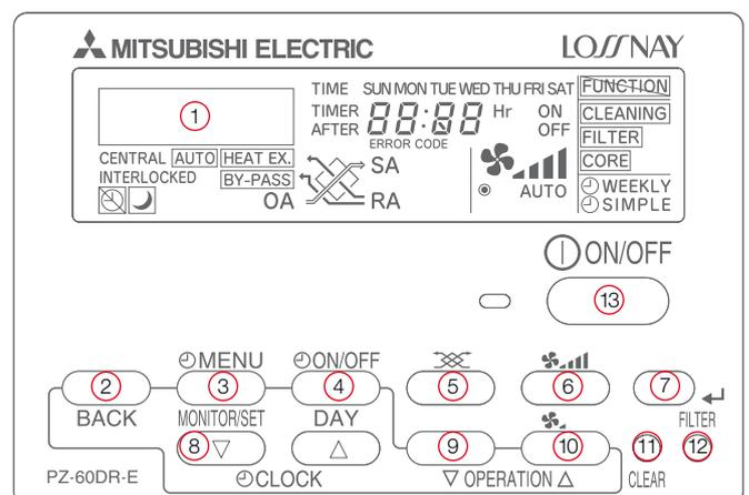
1. Display, 2. Retroceso, 3. MENU de programación (Visualizar/ Operar), 4. Programador (Encendido/Apagado), 5. Selección de funciones, 6. Ajuste de velocidad de ventilación, 7. Enter, 8. Ajuste horario (Bajar/Subir), 9. Ajuste funciones (Función Anterior/ Función Siguiente), 10. Modo de funcionamiento Extra Low, 11. Borrado, 12. Filtro, 13. Encendido/Apagado
